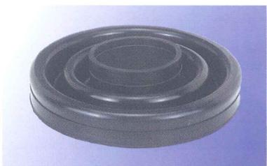
K uzavření konců chráničky slouží manžety na chráničky. Manžety brání vnikání spodní vody a různých živočichů nebo nečistot do chráničky. Nasazují se na trubku v průběhu montáže a upevňují se utažením nerezových pásků, které jsou k manžetě přiloženy při dodání. Manžeta je vyrobena ze syntetického kaučuku EPDM, který je odolný proti
