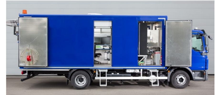
Vybavení kontrolního vozu na kanalizaci s vysokotlakým proplachovacím zařízením
