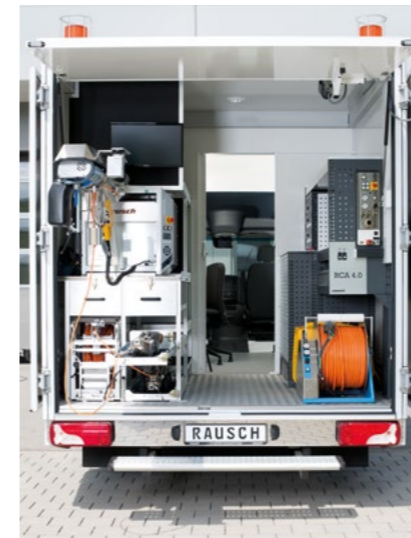
Vybavení vozu Sprinter skříňovou nástavbou z důvodu zvýšených nároků na prostor
